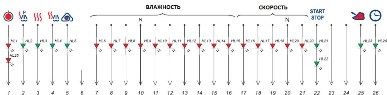
Схема электрическая соединения светодиодов
